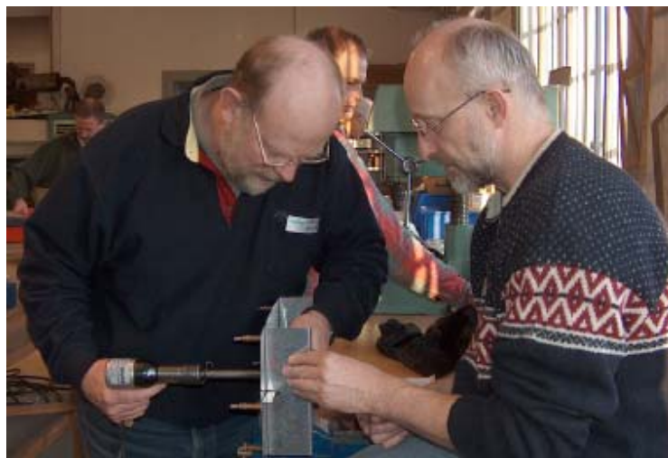
Nitning med trykluftpistol og modhold
